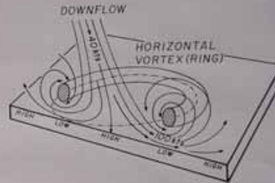
ダウンバースト：環状・水平軸の渦 (上から下へ吹き降ろす力)
