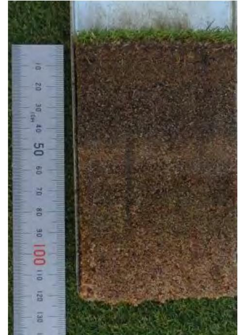
USGA方式グリーン、9月末φ8mmコアリング施工(施工深度8cm)
